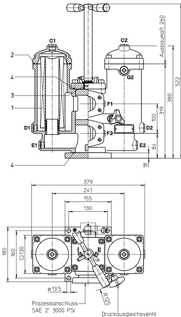
Stellung I: Linke Filterseite in Betrieb
