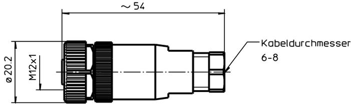
SS5 = M12, 8-pol. Steckbuchse mit 5m Kabel und 3 eingebauten LED's rot/gelb/grün (Art.-Nr. 347370)
