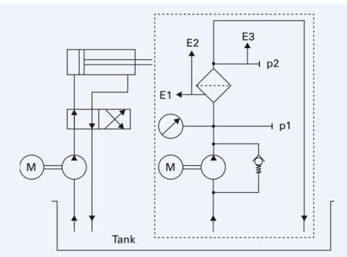
Bei der Offline-Filtration befindet sich der Filter in einem vom Hauptsystem getrennten Kreislauf. Durch die Trennung der Systeme kann die Offline-Filtration, unabhängig von der Laufzeit des Systems, bis zum Erreichen der gewünschten Fluidreinheit erfolgen.
