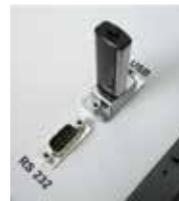
Das CCS 4-Kontaminationskontrollsystem verfügt über RS-232- sowie USB-Schnittstellen und wird mit einer Vielzahl von Zubehörteilen geliefert.
