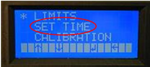
Über diese Funktion wird die Echtzeituhr, welche im Gerät integriert ist, eingestellt.
