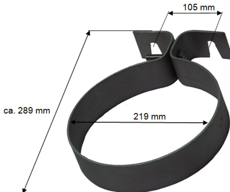
Behälterschellensatz (Paar) bestehend aus Schelle, je einer Sechskantschraube und Sechskantmutter (M10). Die Schelle ist für die Beutelfiltergehäuse SIDELINE (SBF) und TOPLINE (TBF) der Größen 01 und 02 einsetzbar und ermöglicht eine Wandmontage.
