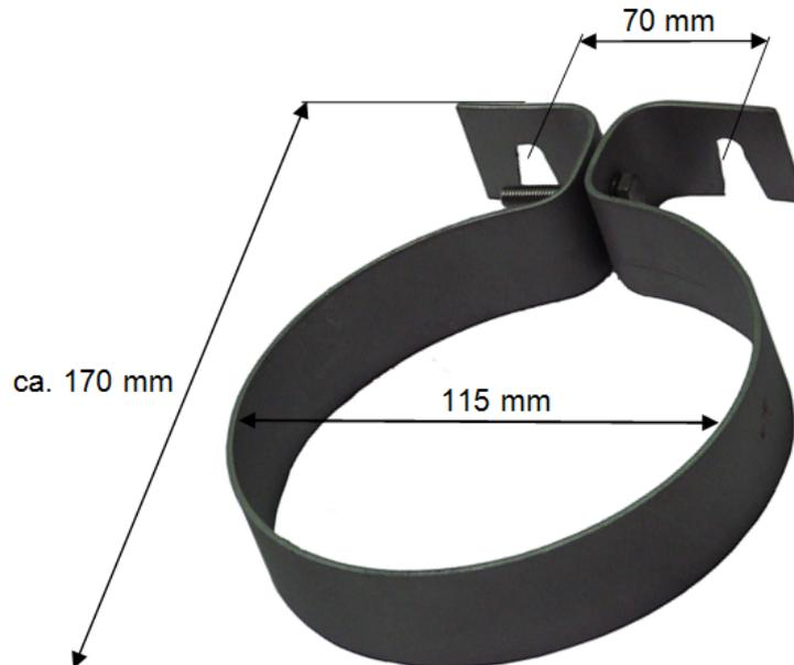
Behälterschellensatz bestehend aus Schelle, einer Sechskantschraube und Sechskantmutter (M10). Die Schelle ist für die Beutelfiltergehäuse ECOLINE (EBF) und SIDELINE (SBF) der Größen 03 und 04 einsetzbar und ermöglicht eine Wandmontage. Das Beutelfiltergehäuse kann individuell in der Höhe und frei in der Orientierung des Zulaufanschlusses N1 montiert werden.
