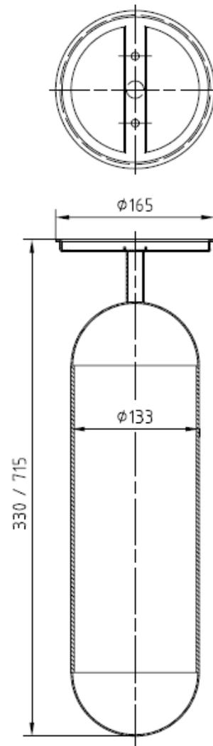
Durch Einsetzen eines Verdrängerkörpers in einen Filterbeutel wird die Restmenge im Filterbeutel und damit der Produktverlust minimiert. Der Filterbeutelwechsel wird erleichtert und Druckgasanschlüsse am Filter zum „Leerdrücken“ sind nicht notwendig. Ein spezieller „Kragen“ sorgt für perfekten und festen Sitz des Verdrängerkörpers im Filterbeutel (kein Durchscheuern oder Erosion des Filterbeutels). Der Verdrängerkörper aus Edelstahl ist bis 16 bar druckfest.
