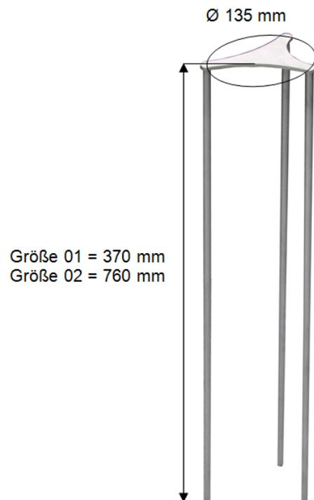
Notwendiges Hilfsmittel zum Einsetzen von HAYFLOW-Filterelementen in den HAYFLOW-Druckaufnahmekorb.
