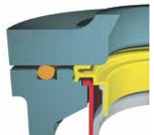
Der durch druckaktivierte Dichtungsring der SENTINEL-Filterbeutel reagiert auf den Anstieg des Differenzdrucks
