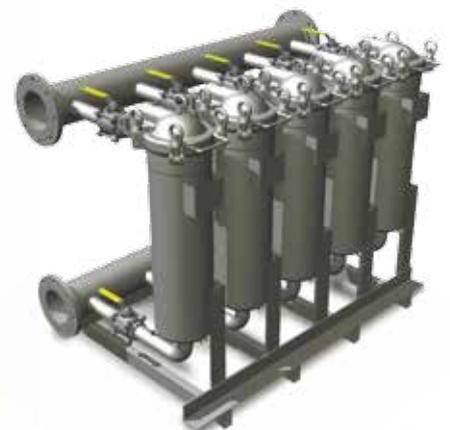
**TOPLINE** Einplätziges Beutelfiltergehäuse aus Edelstahl, das zu den besten seiner Klasse gehört – von der Hochleistungs-konstruktion bis hin zu den leistungsstarken Feingussteilen. Dank der Ausführung mit Einlass an der Oberseite ist weniger Freiraum erforderlich und die Flüssigkeit kann direkt durch den Deckel strömen. Dadurch wird eine verbesserte Abdichtung gewährleistet, der Produktverlust minimiert und der Filterbeutelwechsel vereinfacht.
