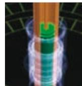
L'actionnement pneumatique déplace l'aimant interne verticalement dans l'arbre, et l'aimant externe sur le disque de nettoyage le suit. Il en résulte un actionnement puissant, sans liaison physique passant à travers la cuve.
