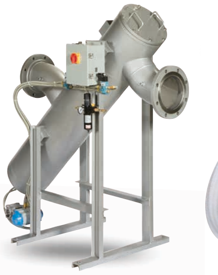
Siebkorbfiltermodell MCS-1500 für Hochleistungsanwendungen. Die magnetisch gekoppelte Stellvorrichtung macht dynamische Dichtungen überflüssig.
