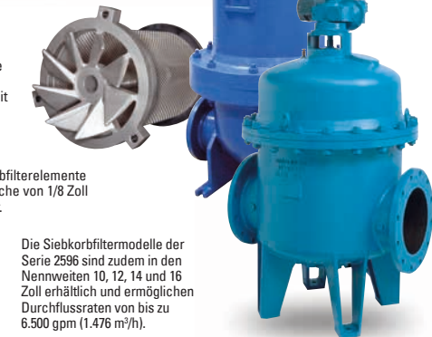
Die Siebkorbfilter für Nennweiten von 2 bis 9 Zoll sind mit der Cerapelle™-Technologie ausgestattet, die die einströmende Flüssigkeit in eine wirbelnde Bewegung versetzt und so einen effizienteren Rückspülungsprozess ermöglicht. Die Siebkorbfilterelemente sind für Rückhaltebereiche von 1/8 Zoll bis 25 Mikron verfügbar.
