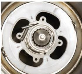
Eatons einzigartiger federbelasteter Reinigungsschaber (hier in einem MCS-500) gewährleistet engen Kontakt zum Filtersieb sowie gründliche und gleichmäßige Reinigung des Filters.
