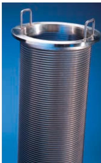
**Grille à fentes** – Les grilles de filtre DCF/MCF/MCS comportent une grille à fentes spéciale rodée pour être parfaitement circulaire afin de garantir un contact avec le disque de nettoyage pour que les fentes soient les plus petites à la surface de la grille. Cette conception évite le bouchage des fentes par les particules tout en assurant une élimination complète des solides retenus.
