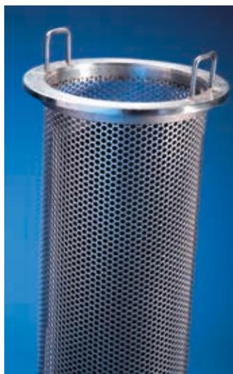
**Perforé** – Les grilles perforées comportent des structures de perforation précises et uniformes pour une élimination complète des solides plus volumineux. Ces éléments sont idéaux pour une filtration de grands volumes de fluides visqueux. Des perforations de 1/16", 1/8" et 1/4" sont disponibles.
