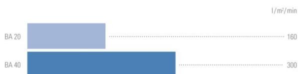
Conditions :  $\Delta p = 100 \text{ kPa}$ , solvant : eau à 20 °C
