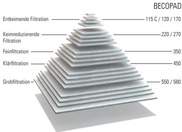
BECOPAD-Tiefenfiltermedium wird in neun Klärschärfen angeboten, von der Grob- bis zur entkeimenden Filtration.
