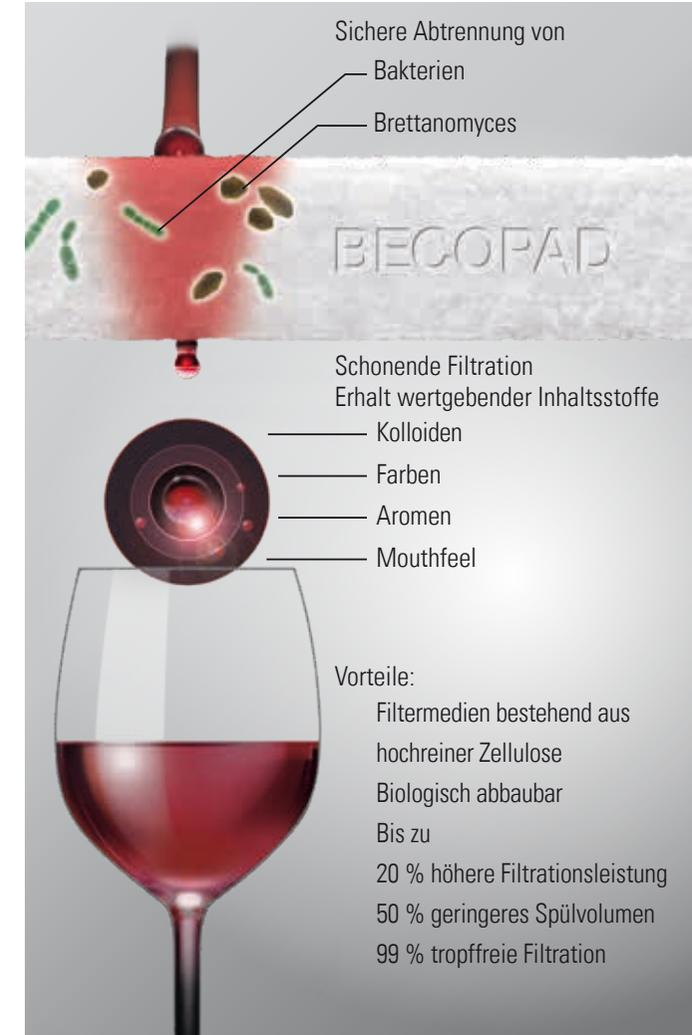
Brettanomyces Hefen werden bei einer Klärfiltration mit BECOPAD 450 stark reduziert. Alle feineren Filterschichten-Typen BECOPAD 350, BECOPAD 270, BECOPAD 220, BECOPAD 170 und BECOPAD 115C garantieren Brettanomyces-freie Weine.
