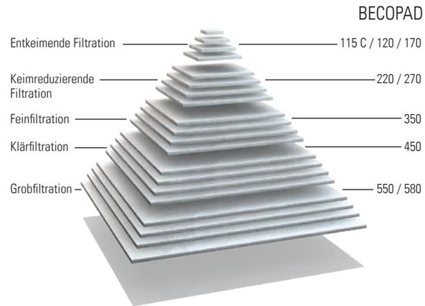
BECOPAD-Tiefenfilterschichten werden in neun Klärschärfen angeboten, von der Grob- bis zur entkeimenden Filtration.
