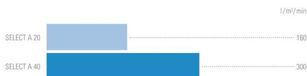
Condições:  $\Delta p = 100 \text{ kPa}$  (1 bar), Meio: Água a 20 °C
