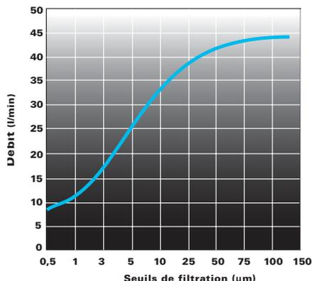
\* Pour les liquides autres que l'eau, multiplier la différence de pression par la viscosité du liquide en centipoise.
