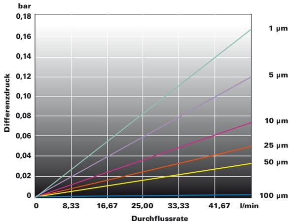
\* Für andere Flüssigkeiten als Wasser multiplizieren Sie den Differenzdruck mit der Viskosität in Centipoise.
