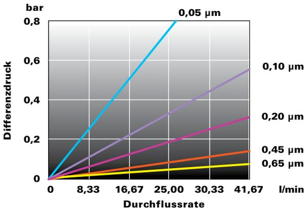
\* Für andere Flüssigkeiten als Wasser multiplizieren Sie den Differenzdruck mit der Viskosität in Centipoise.
