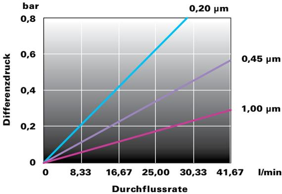
\* Für andere Flüssigkeiten als Wasser multiplizieren Sie den Differenzdruck mit der Viskosität in Centipoise.
