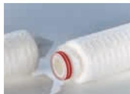
**Código 2:** Abierto por un lado (SOE), juntas tóricas 2-222, adaptador de bayoneta triple con punta de centrado, diámetro exterior 44 mm (punto más bajo)
