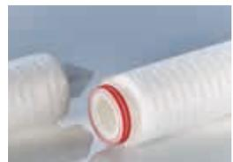
**Código 7:** Abierto por un lado (SOE), junta tórica 2-226 adaptador de bayoneta doble con punta de centrado, diámetro exterior 56 mm (punto más bajo)
