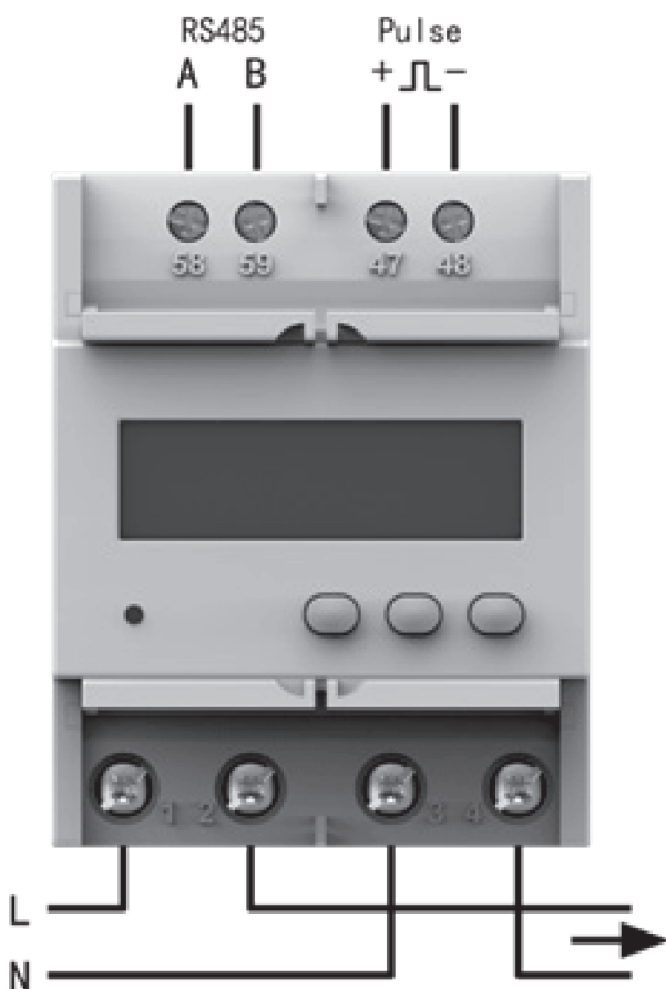
Abbildung 7: Kabelklemmen des SFERE-Energieflussrichtungssensors
