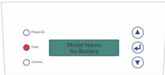
Abbildung 49: Displaymeldung des Hybrid-Wechselrichters, die auf einen Verbindungsverlust mit dem Batteriemodul hinweist.
