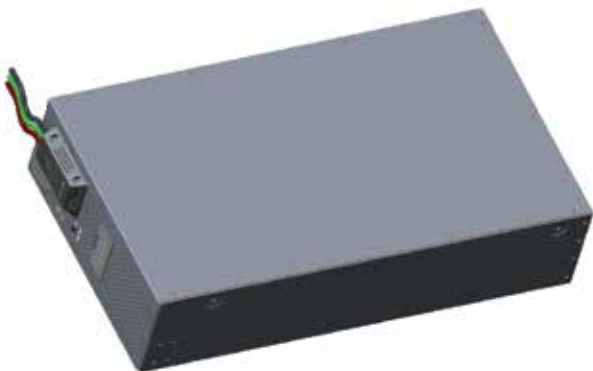
Abbildung 39: 3D-Ansicht des xStorage Home-Hybrid-Wechselrichters
