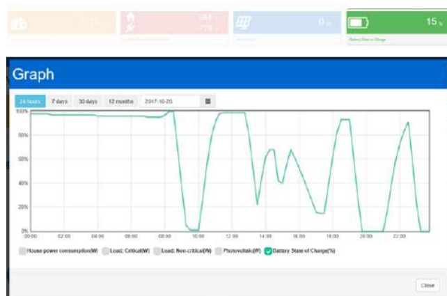
Figure 27 : Graphique d'état de charge de la batterie
