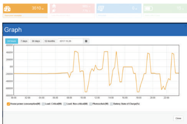
Figure 24 : Graphique de la consommation d'énergie du logement
