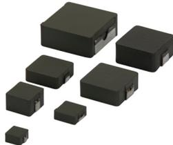
磁屏蔽来降低 EMI。HCMA 可在 + 85 °C 环境温度下运行，而 HCM1A 可在 + 125 °C 环境温度下运行，两者的最高总温分别为 + 125 °C 和 + 155 °C。可选择对其外部进行全涂层处理，以便在恶劣环境下提供 100% 防腐保护。常见应用包括 ECU、信息娱乐系统、TCU、LED 照明、水泵、燃料泵、油泵、发动机冷却风扇和 HVAC 单元。
