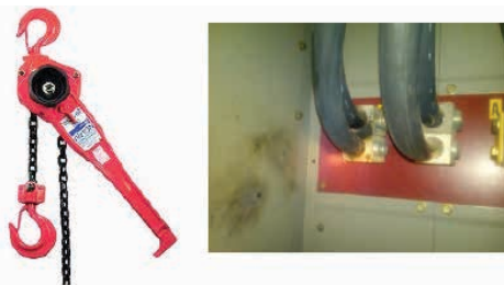
Figure 11 À gauche, le palan manuel à levier utilisé pour les travaux sous tension, et à droite, les dommages causés au panneau après l'éclair d'arc phase-terre en présence d'un dispositif en amont ayant des fonctionnalités de maintenance réglables.
