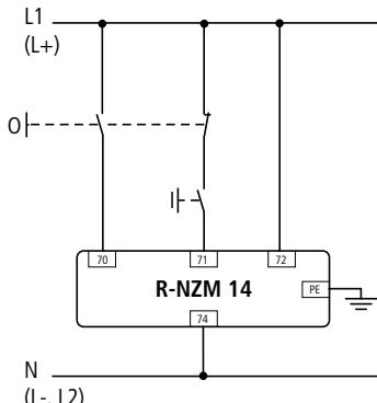
Der Leistungsschalter kann bei spannungslosem Unterspannungsauslöser nicht eingeschaltet werden.
