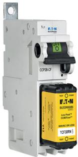
El desconectador derivado con protección para dedos, clasificado en caballos de fuerza y con rechazo por ampacidad CCPB (hasta 100 A) y CCP (200 A) están disponibles en versiones de 1, 2 y 3 polos para ayudar a evitar el sobredimensionamiento. El CCPB acepta fusibles CUBEFuse con retardo de tiempo o de acción rápida, y el CCP acepta fusibles CUBEFuse con retardo de tiempo, para cumplir con los requisitos de protección de la carga.
