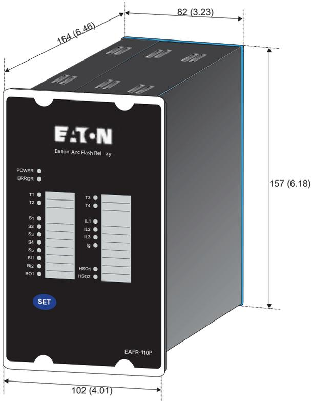
Figura 9. Corte para montaje en tablero del EAFR-110 en milímetros (pulgadas)
