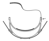
⑤ Una vez que la correa elástica esté ajustada, doble los extremos de la careta para deslizar las muescas exteriores detrás de las clavijas de la pieza para la cabeza. Desmonte invirtiendo los pasos anteriores.
