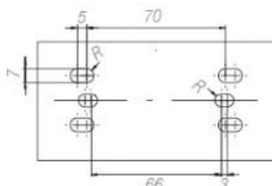
Medidas (mm) para EBH1 adecuado para instalación en placas de montaje
