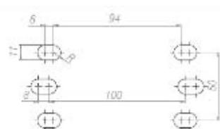
**Medidas (mm) para EBH2 adecuado para instalación en barra colectora de 60 mm**
