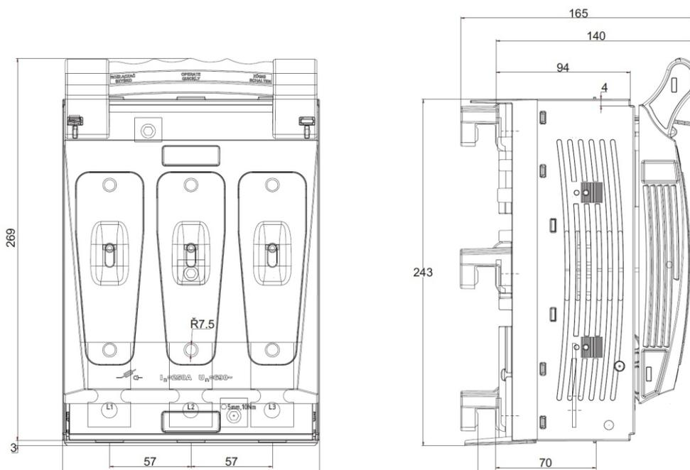
**Medidas (mm) para EBH2 adecuado para instalación en placas de montaje**
