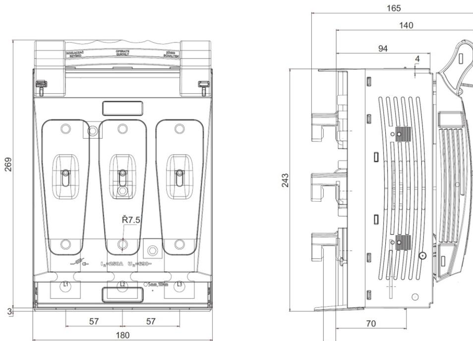
**Medidas (mm) para EBH1 adecuado para instalación en barra colectora de 100 mm**
