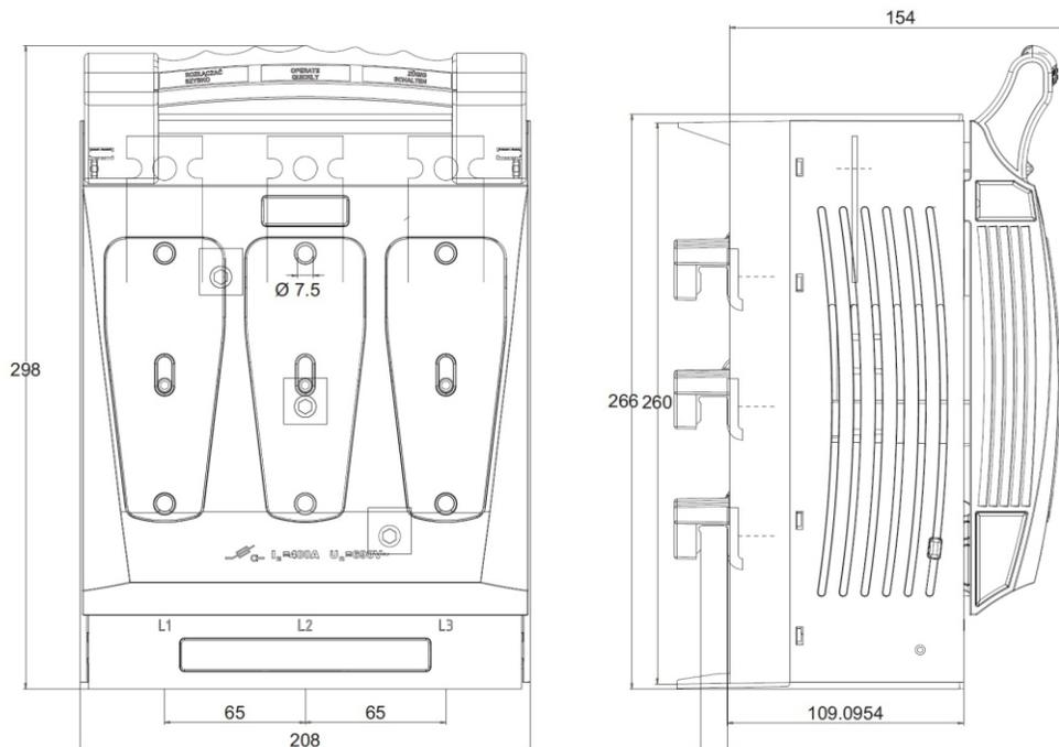
**Medidas (mm) para EBH2 adecuado para instalación en barra colectora de 100 mm**
