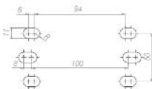
**Medidas (mm) para EBH1 adecuado para instalación en barra colectora de 60 mm**
