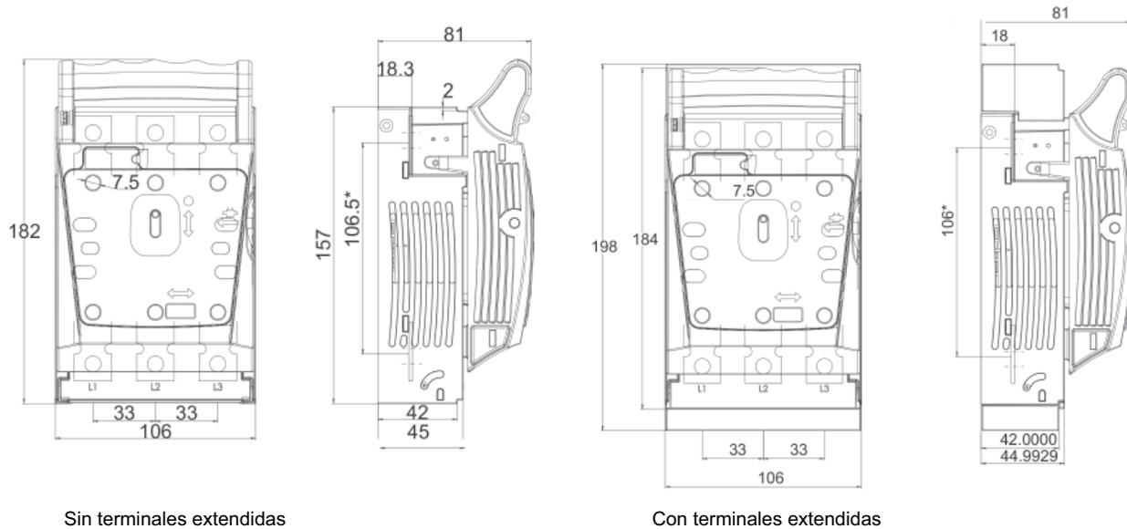
Medidas y espaciado de orificios para instalación en placas de montaje
