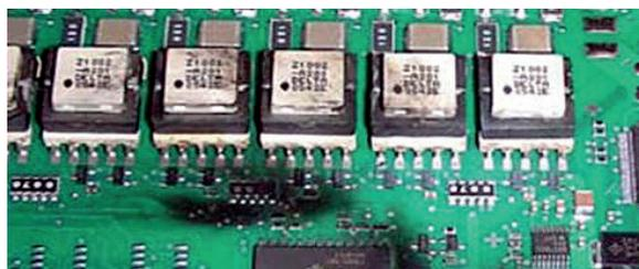
Daño interno. Tarjeta de circuito impreso destruida por sobretensión
