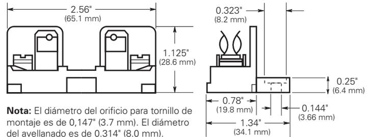
**Nota:** El diámetro del orificio para tornillo de montaje es de 0,147" (3,7 mm). El diámetro del avellanado es de 0,314" (8,0 mm). Tornillo de montaje Núm. 6, máx.
