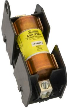
Los bloques para fusibles de casquillo de 30 y 60 amperios tienen capacidad de montaje en riel DIN y en tablero. Su diseño modular permite agruparlos a presión para formar el número de polos requerido. Aceptan cubiertas a presión, opcionales, con protección para dedos, IP20, y cuentan con capacidad de bloqueo-etiquetado con el fin de incrementar la seguridad eléctrica.
