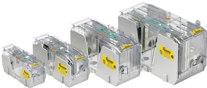
Los bloques para fusibles de navajas de 100 a 600 amperios se montan en tablero con múltiples orificios para mayor flexibilidad de instalación y su diseño modular permite agruparlos a presión para formar el número de polos requerido. Aceptan cubiertas a presión, opcionales, con protección para dedos, IP20, y cuentan con previsión para bloqueo-etiquetado para mayor seguridad eléctrica.
