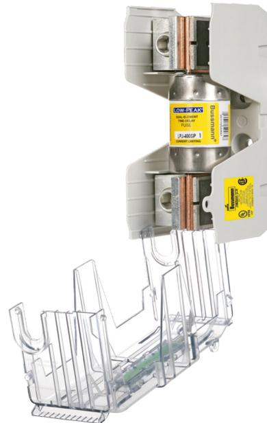
En bloques con clasificación de 100 a 600 A, las cubiertas opcionales pueden retirarse completamente para dar servicio o simplemente abrirse por medio de la bisagra.
