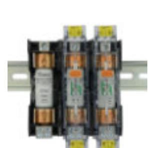
Bloques modulares de 250 volts y 60 amperios con terminales de 1 puerto en el lado de línea y terminales de 4 puertos en el lado de carga y cubiertas con protección para dedos (IP20), opcionales.
