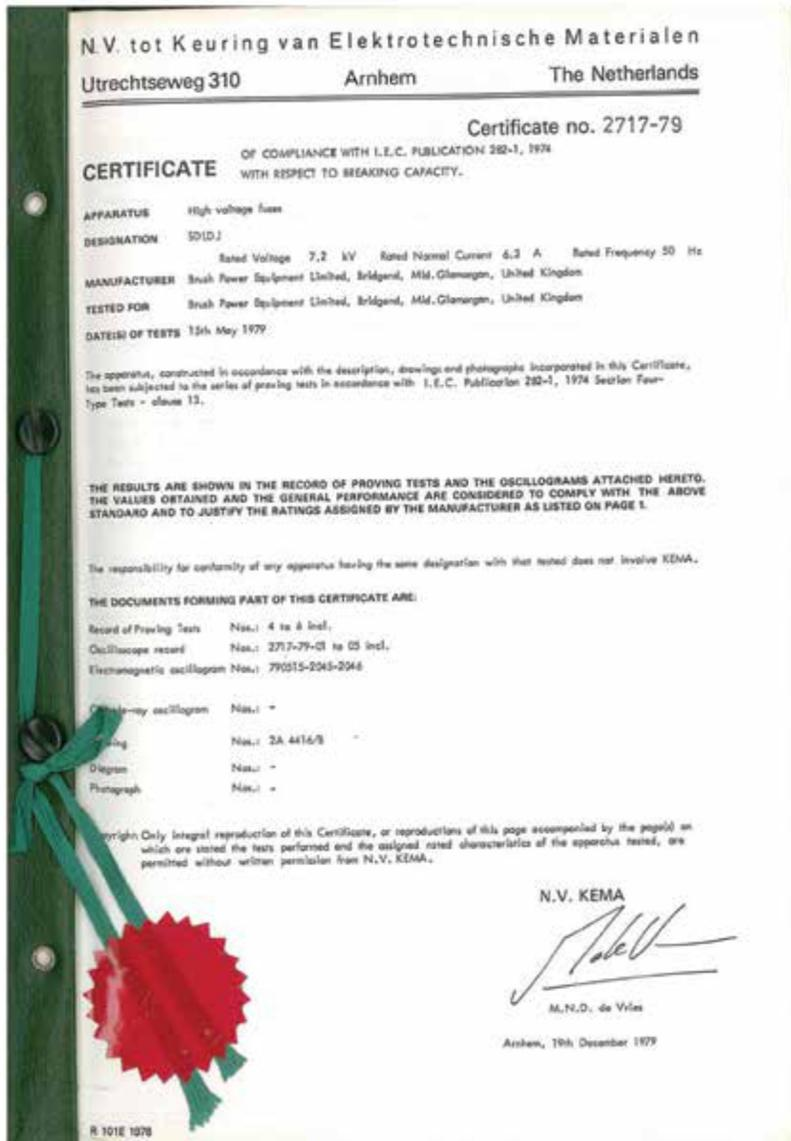
Este certificado se refiere a los fusibles SLDJ, 7.2 kV, que son idénticos, eléctricamente, a los fusibles de la nueva gama T, excepto que están sellados para usarse en exteriores, tienen cuerpo de cerámica color marrón y utilizan percutor de 50 N.
