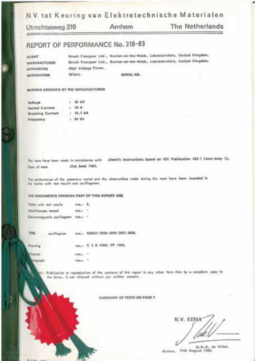
Este informe de cumplimiento se refiere a los fusibles SFQAJ, 36 kV, que son eléctricamente idénticos a los de la nueva gama T, con la diferencia de estar sellados para usar en exteriores, tienen un cuerpo de cerámica color marrón y utilizan un percutor 50 N.
