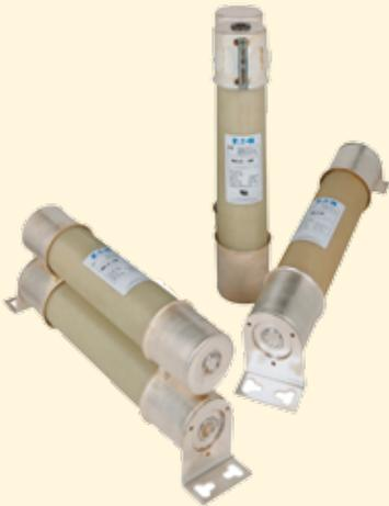
Nuestros fusibles de media tensión con clasificación R y limitación de corriente son fusibles de respaldo, adecuados para uso en interior o exterior, para aplicaciones en las que es necesario limitar las corrientes de cortocircuito en sistemas de gran capacidad. Generalmente se usan para proteger impulsores y arrancadores de media tensión.
