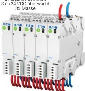
Selten wird an eine Absicherung nur eine einzelne Last angeschlossen, üblich ist der Anschluss von 2 oder 3 Lasten. Dazu musste bisher der Ausgang der Absicherung in einem separaten Klemmblock weiterverteilt werden. Ein Aufbau, der fehleranfällig und mit unverhältnismäßigem Aufwand verbunden ist. Der PXS24 verfügt über jeweils 3 Plus- und 0V-Klemmen direkt am Gerät. Damit werden komplizierte, fehleranfällige Verdrahtungen überflüssig.
