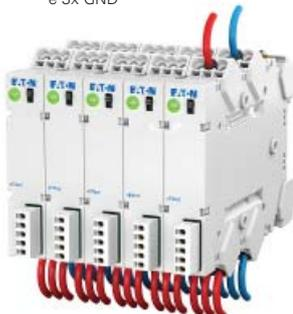
Un interruttore è di rado collegato ad un solo carico, di solito ne supporta 2 o 3. Fino ad oggi, era necessario collegare l'uscita dell'interruttore ad una morsettiera separata. Questa configurazione è facilmente soggetta ad errori ed è eccessivamente ingombrante. PXS24 è dotato di tre morsetti integrati per +24 VDC e GND. Questo elimina la necessità di un cablaggio complesso e che rischia di essere soggetto ad errori.
