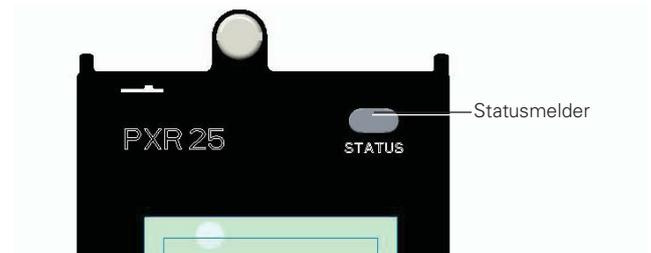
Der Statusmelder blinkt rot, wenn die Auslöseeinheit ein internes Problem feststellt. Dies weist auf ein Problem mit der Aktorspule der Auslöseeinheit, einen Firmware-Fehler, einen Kalibrierungsfehler oder einen Fehler des Mechanismus hin. Es müssen sofort Maßnahmen ergriffen werden, um das Problem zu beheben und/oder die Auslöseeinheit zu ersetzen. Siehe Anhang B – „Fehlerbeseitigung“ für Details.
