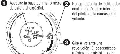
contra el diámetro interior del piloto de la carcasa del volante.
