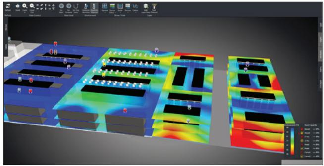
整個資料中心的溫度資料可用於建構溫度分佈圖，從而識別熱點和過冷區域。
