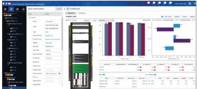
機櫃儀表板提供了機櫃所需的全部資料，同時直觀地呈現 PDU 的 A/B 故障切換分析和負載平衡。
