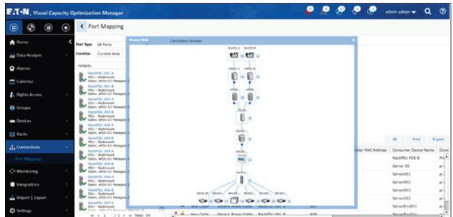
Port Mapping 功能：讓用戶能夠查看整個資料中心的電源、網路和光纖連接，以快速執行故障和影響分析。
