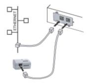
센서는 주기적으로 온도 및 습도를 측정하고 두 외부 접점의 상태를 확인하여 ATS 환경을 원격으로 모니터링합니다. 사전 설정된 임계 값으로 트립 된 알람 (이메일, SNMP트랩)을 보낼 수도 있습니다. 네트워크 카드-MS의 서비스포트 (설정/센서)를 통해 연결합니다. 센서가 자동으로 감지됩니다. 홈페이지에 직접 접속하여 아래 메뉴를 사용하여 구성하고 확인합니다.
