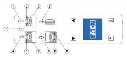
ePDU 전면 패널은 통신 및 모니터링 포트, LED 상태 표시장치 및 작동 버튼을 포함하고 있습니다. 포트 및 관련LED 표시장치들은 아래 표에 설명되어 있습니다.
