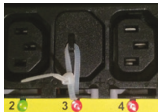
Le capuchon se fixe en place avec une attache de câble
