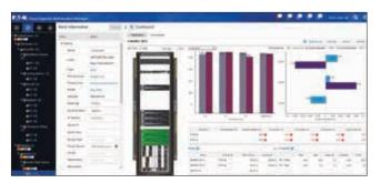
Le tableau de bord du rack fournit toutes les données nécessaires tout en affichant les analyses de basculement A/B et l'équilibrage de la charge des PDU.
