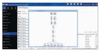
Le Port Mapping permet aux utilisateurs de visualiser les raccordements d'alimentation, de réseau et de fibre optique dans l'ensemble du data center afin de réaliser rapidement des analyses de défaillance et d'impact.
